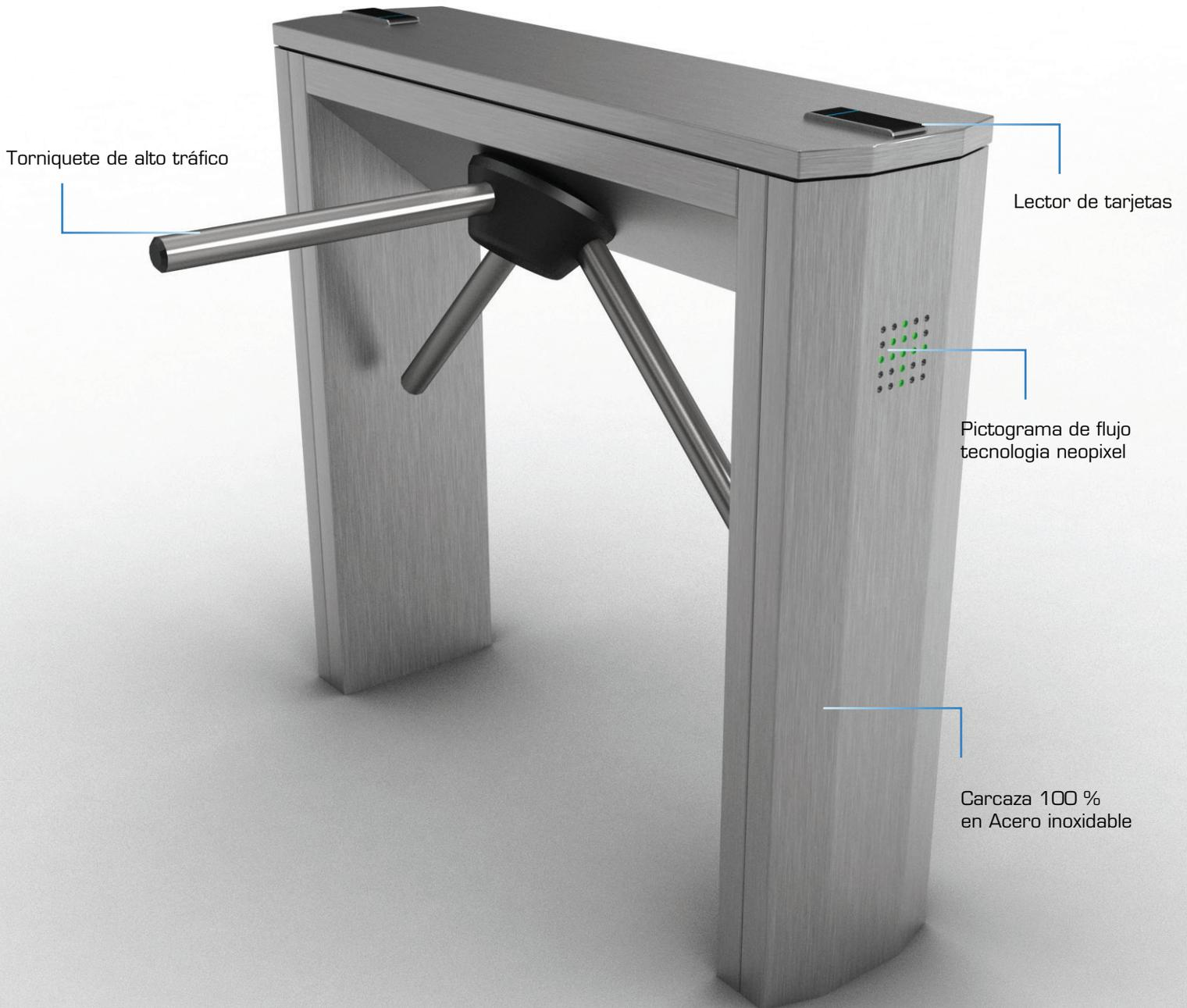
Es un diseño moderno totalmente en acero inoxidable especial para espacios reducidos, permite el paso en ambos sentidos y se integra con otras tecnologías de acceso. . El mecanismo de bloqueo es de bajo mantenimiento y altamente eficaz gracias a su diseño sólido y al uso exclusivo de electroimanes en lugar de solenoides de bajo costo.
