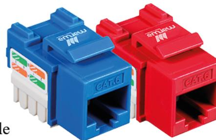
El jack de pared ofrece una carcasa de plástico de alto impacto y retardante de llama (UL 94V0) Cumple y supera la norma internacional ISO / IEC 11801 y los requisitos ANSI/TIA-568-C.2 Conectores IDC tipo doble, ubicados a 180° en relación con los puertos RJ45, terminados mediante herramienta de inserción tipo 110 Codificado por colores para instalaciones T568A y T568B.
